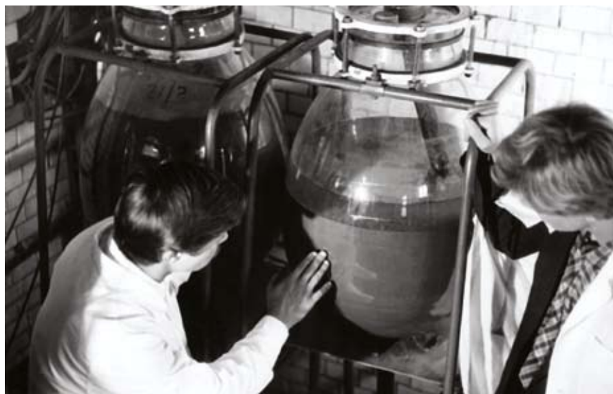
Рис. 15. Водное разделение и отстаивание суспензии наноалмазов на технологической фазе обогащения
