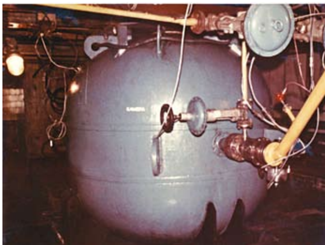
Рис. 9. Промышленная взрывная камера V = 3,0 \text{ м}^3
