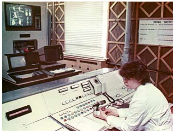
Рис. 10. Центральный пульт управления технологическими процессами
