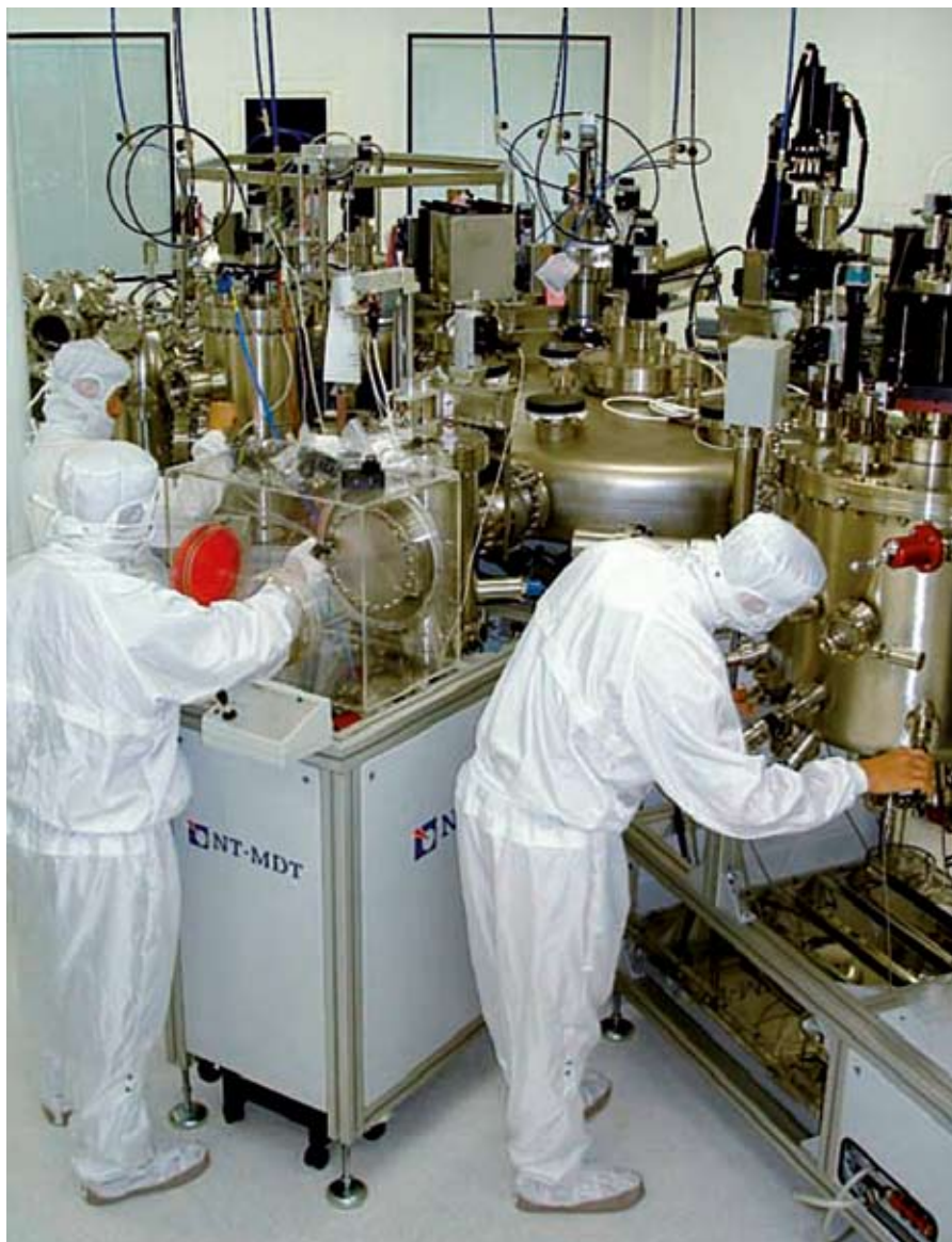
Рис. 3. Многофункциональный сверхвысоковакуумный НТК НАНОФАБ 100 в НОЦ «Нанотехнологии», ТТИ ЮФУ
