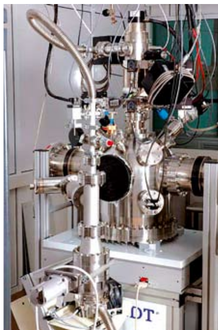
Рис. 6. НТК НАНОФАБ 100: модули FIB Implant+SEM+SIMS
