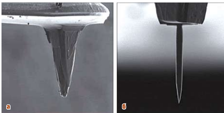
Рис. 4. «Заточка» зонда для атомно-силового микроскопа (АСМ) с помощью ФИП. Изображение типичного зонда до «заточки» (а) и после (б). Образец получен с использованием комплекса НАНОФАБ 100 в лаборатории проф. В.К. Неволина (Московский государственный институт электронной техники — МГИЭТ ТУ)
