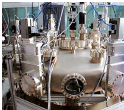
Рис. 7. НТК НАНОФАБ 100: транспортный модуль 6-позиционного робота
