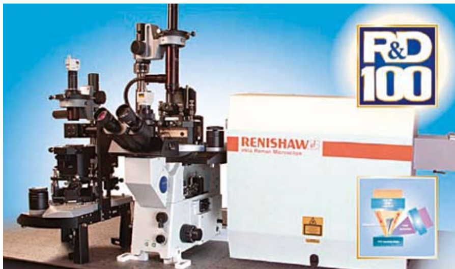
Рис. 3. Зондовая НаноЛаборатория ИНТЕГРА Спектра объединяет возможности АСМ с конфокальной оптической микроскопией и спектроскопией люминесценции и КР
