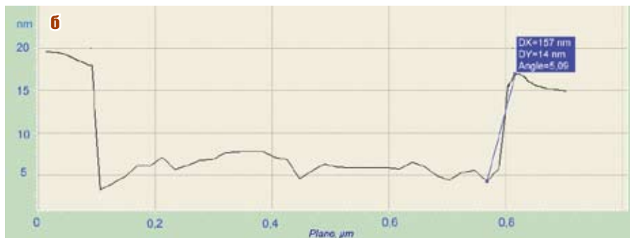
Рис. 4. Графитовая нанолента. Доза ионного пучка d = 0,211 нКл/мкм 2 , ток пучка 10 пА: а — АСМ-изображение, б — характерное сечение модифицированной структуры. (Глубина травления ~13,5 нм)
