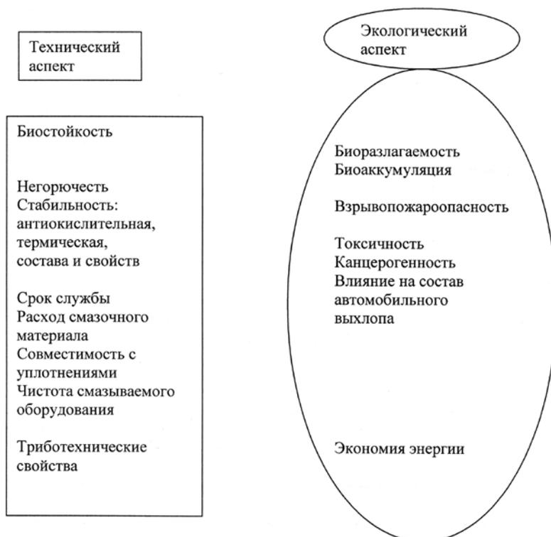
Рис. 4. Взаимосвязь технических и экологических аспектов в применении горюче-смазочных материалов
