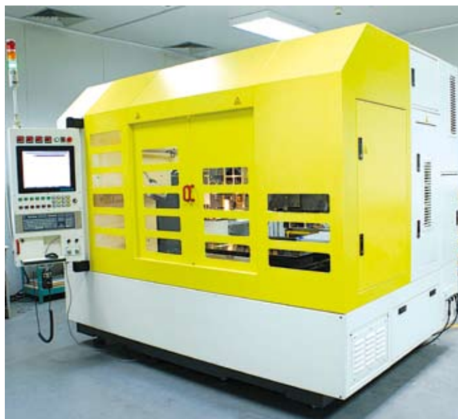
Рис. 5. Общий вид лазерного технологического комплекса для резки и снятия фаски в производстве дисплейных панелей
