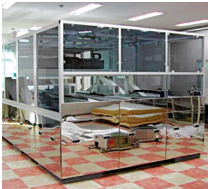
Рис. 4. Установка для резки дисплейных панелей 6-го поколения «Laser 6G LCD Glass Cutter M/C 1»
