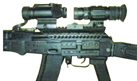
Рис. 6. Совмещение на оружии коллиматорного прицела «Альфа-1964-1» с ночным монокуляром «Альфа-1964-2»
