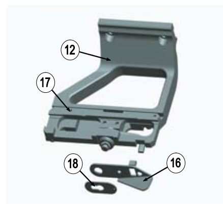
Рис. 4. Установочные детали коллиматорного прицела «Альфа-1964»
