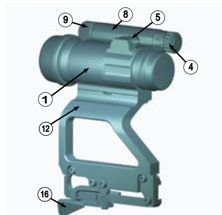
Рис. 3. Корпусные детали коллиматорного прицела «Альфа-1964»
