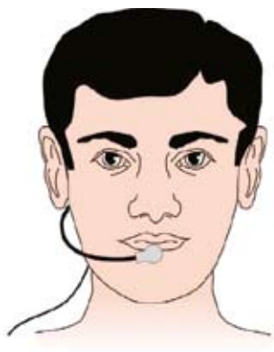
Рис. 3. Датчик, фиксирующий и осуществляющий цифровое преобразование неслышимых слов (без вибрации голосовых связок)
